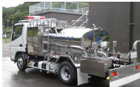
給水車（給水栓・放送設備等を搭載）
