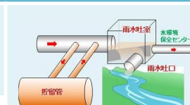
貯留管による対策イメージ
