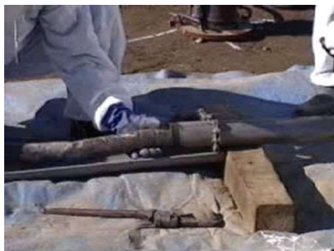
図 7.3.3-4 自走式ボーリングマシン使用例 (サンプラーからの柱状サンプル採取の流れ)
