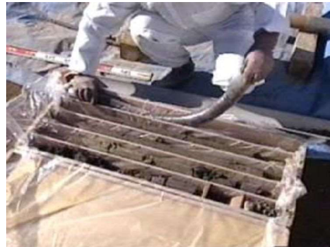
図 7.3.3-4 自走式ボーリングマシン使用例 (サンプラーからの柱状サンプル採取の流れ)
