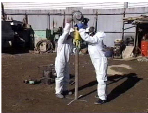
図 7.3.3-3 可搬型ボーリングマシン使用例
