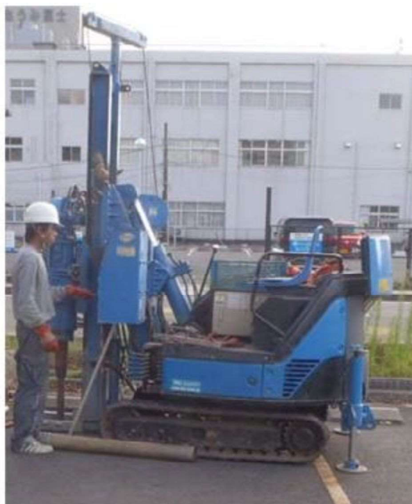
図 7.3.3-3 可搬型ボーリングマシン使用例
