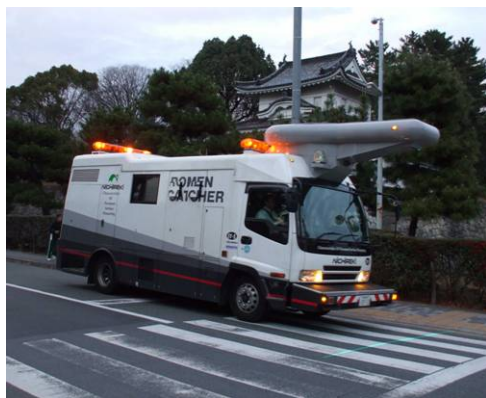
幹線道路における舗装性状調査の様子
