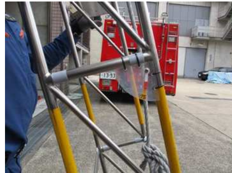
架梯角度確認用表示器の取付状況
