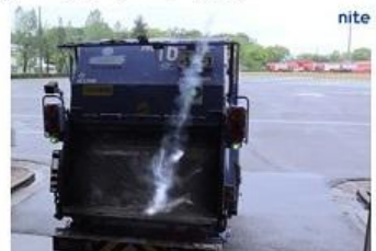
⑤バッテリーの破裂
