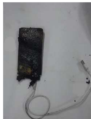
【スマートフォン（リチウムイオン電池）からの出火】
