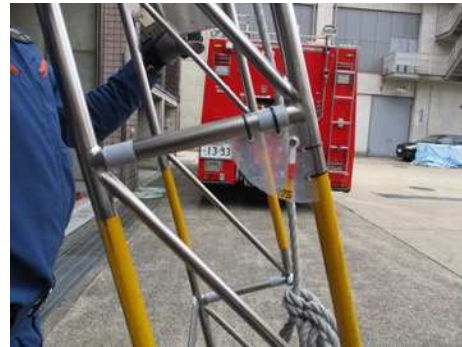
架梯角度確認用表示器の取付状況
