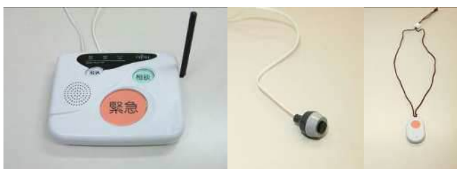
緊急通報システム
