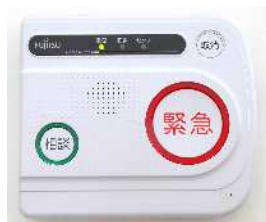
緊急通報システム（本体）
