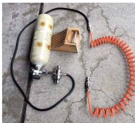
東山消防署 空気ポンプを使用した訓練用消火器への充填
