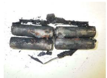
ノート型パソコンのリチウムイオン電池を確認
