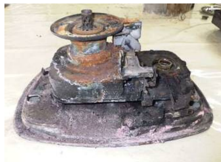
開放式ストーブの燃焼筒、空気取り入れ口を確認
