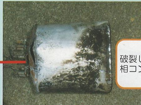
破裂した低圧進相コンデンサ
