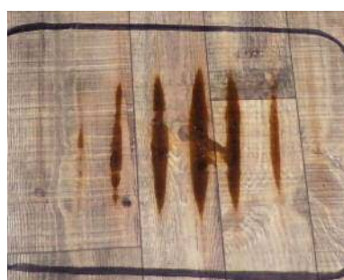
電気カーペット上のカバーラグの変色の再現実験
