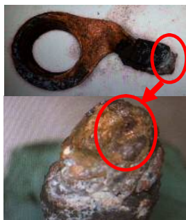
車両の配線の断線部に亜酸化銅を確認。
