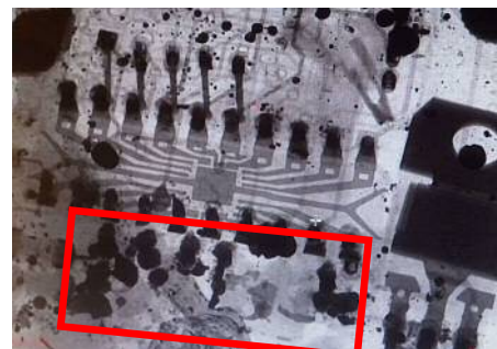
X線透過装置で、トラッキングを発見した。
