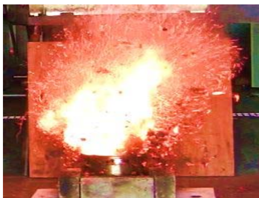
円筒型リチウムイオン電池の発火状況
