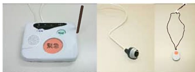
緊急通報システム
