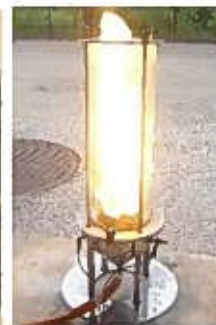
アルミ粉の粉塵爆発再現実験
