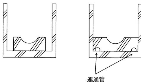
カ コンクリートパーツ組立て方法によりタンク室を設置することは差し支えない。ただし、基礎コンクリート据付け時の水平度、捨てコンクリートと基礎コンクリートとの密着性、接合用ボルト等の防食措置、パーツとパーツとの接合状況等その施工について十分配慮するよう指導すること。(S58危29)
