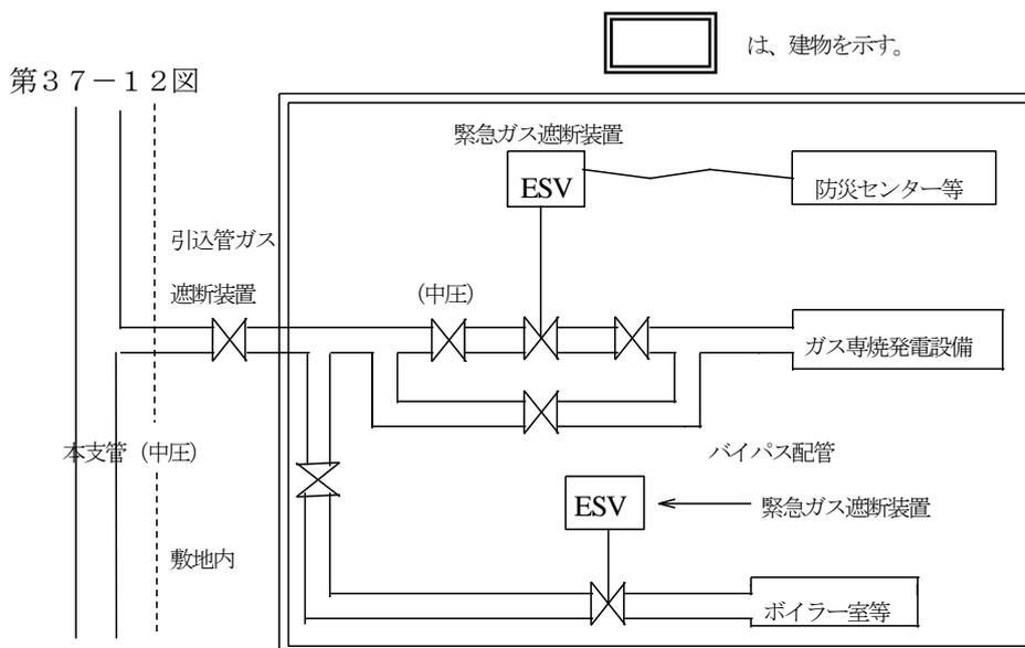
キ 常用防災兼用ガス専焼発電設備が設置されている部分には、ガス漏れ火災警報設備を設置すること。ガス漏れ火災警報設備の検出部は、常用防災兼用ガス専焼発電設備の設置されている部屋、キュービクル内（エンクロージャーを含む。）、ガス供給管の外壁貫通部及び非溶接接合部付近に設けるものとし、当該ガス漏れ火災警報設備の受信機は、防災センター等に設けること。
