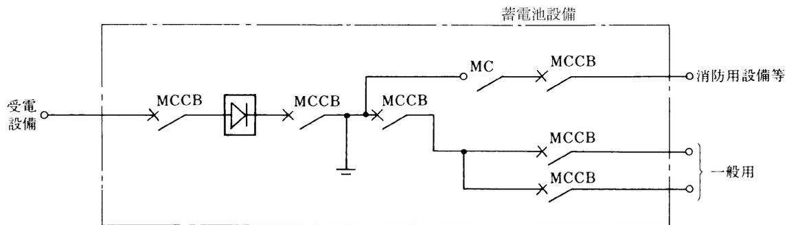
(注) 略号の名称は、MCCBは配線用遮断器を、MCは電磁開閉器を示す。以下この項の図において同じ。
