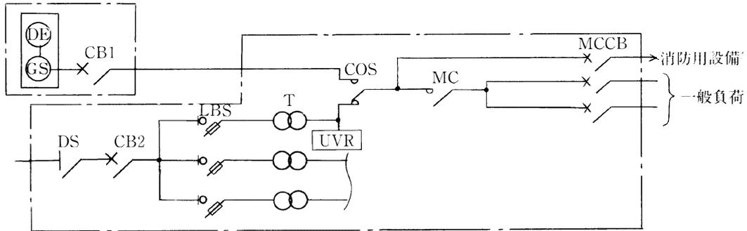
(注) UVRは、変圧器の2次側から自動切り替え装置までの間に設けること。
