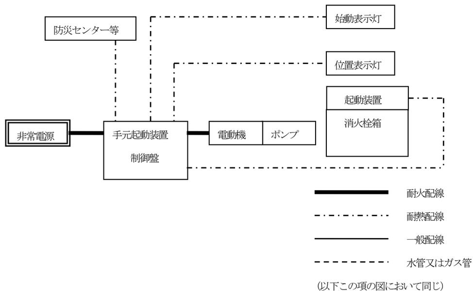
イ スプリンクラー設備、水噴霧消火設備及び泡消火設備の場合（第37-16図参照）
