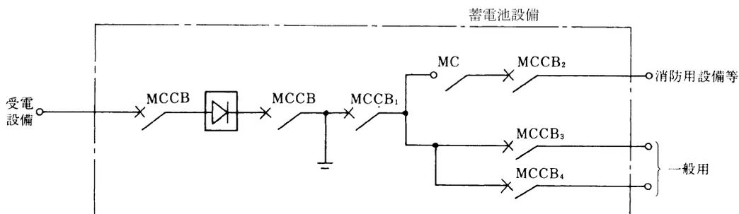
(注) 主遮断器MCCB1は過負荷及び短絡時にMCCB3、MCCB4より先に遮断しないものであること。
