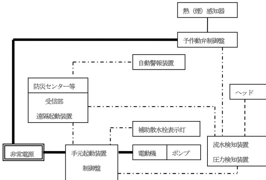
ウ 不活性ガス消火設備、ハロゲン化物消火設備及び粉末消火設備の場合（第37-17図参照）
