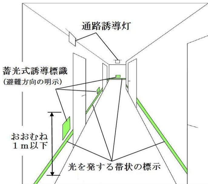
(5) 階段、傾斜路、段差等に設ける蓄光式誘導標識は、次によること。
