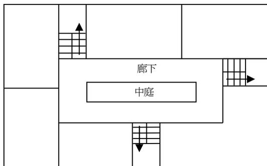
(3) 階段、エレベーター、便所等が防火対象物の中心部に集中したコア形式の防火対象物は、いずれの部分で火災が発生しても異なる2方向に避難できるよう、2以上の直通階段が設けられ、かつ、これらの階段の間隔が水平距離にして30m以上となるように設けられている場合（第29-6図参照）
