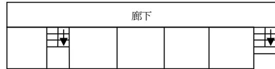
(2) 防火対象物の周囲（内側を含む。）に廊下が設けられ、いずれの部分で火災が発生しても異なる2方向に避難できるための直通階段が設けられている場合（第29-5図参照）
