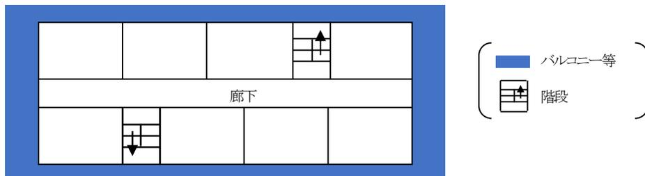
(2) 防火対象物の居室の外気に面する部分及びその他の部分にバルコニー等が設けられ、かつ、当該バルコニー等により、避難階又は地上に通ずる直通階段（傾斜路を含む。以下この基準において「直通階段」という。）のうち、避難階又は特別避難階とした2以上のものに到達できる場合（第29-2図参照）
