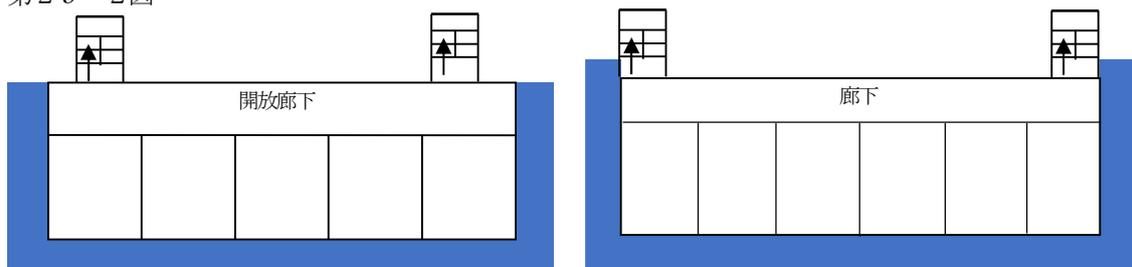
(3) 防火対象物の居室間の隔壁が不燃材料で造られ、当該居室間を相互に連絡できるようバルコニー等が設けられ、かつ、当該バルコニー等により、避難階又は特別避難階とした2以上の直通階段に到達できる場合（第29-3図参照）
