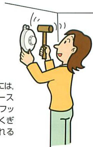
壁や柱に設置する場合には、天井と同様に取付ベースを取り付ける製品と、フックが付いていて、ネジくぎやくぎで、取り付けられるものもあります。
