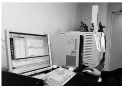
ガスクロマトグラフ質量分析計を用いた鑑識
