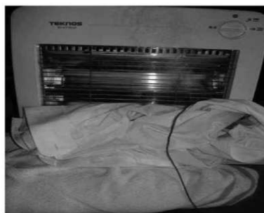
電気ストーブの輻射熱による 出火再現実験
