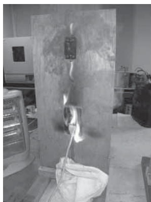
トラッキング現象による出火の再現実験
