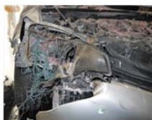
車両の前照灯（ハロゲンバルブ） の取り付け不良による出火事例
