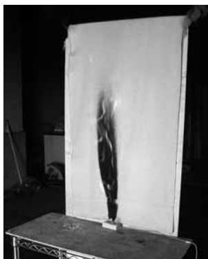
テーブルタップ内部のトラッキング現象による出火
