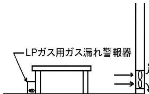
図5 LPガス用ガス漏れ警報器の設置例
