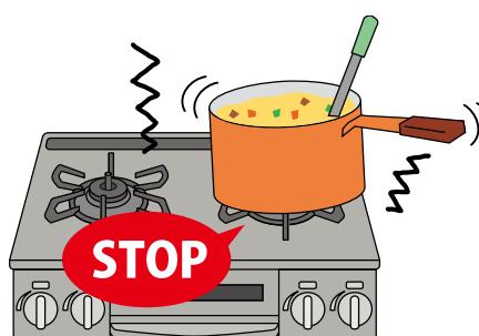
感震停止機能とは、強い揺れ(震度4以上)を感じたときにガスコンロの火を使用していてもガスを遮断し、自動で機器を停止させてくれる安心機能です。(震度5以上の場合はガスマーテーの安全機能も作動し、ガスを遮断します。)
