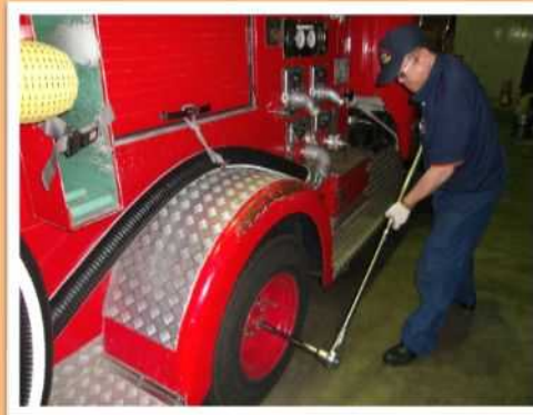
トルクレンチによる締め付け
