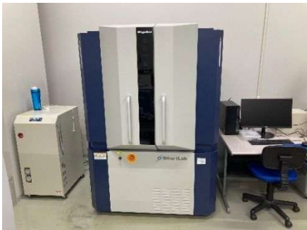
金属、セラミックス、有機物等の結晶構造の解析や化合物の定性、結晶成分の定量等を行うことができる「全自動 X 線回折装置」
