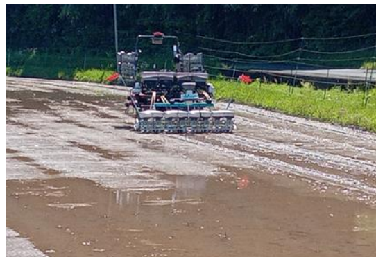
ロボット(無人)田植機による湛水直播作業
