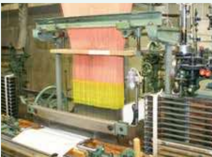
▲ ストープリ社製電子ジャカードを搭載したシャトル織機
