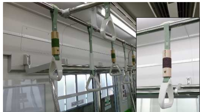
地下鉄 木製吊り手
