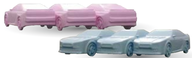
図3 染色CNFを混合した材料着色成形品
