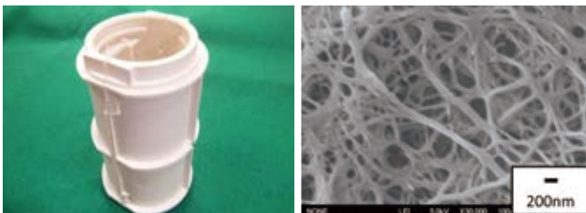
図1 CNF強化成形品と分散したCNF
