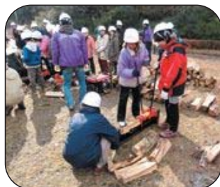
バーを動かすだけで誰でも簡単にできる手動式薪割機
