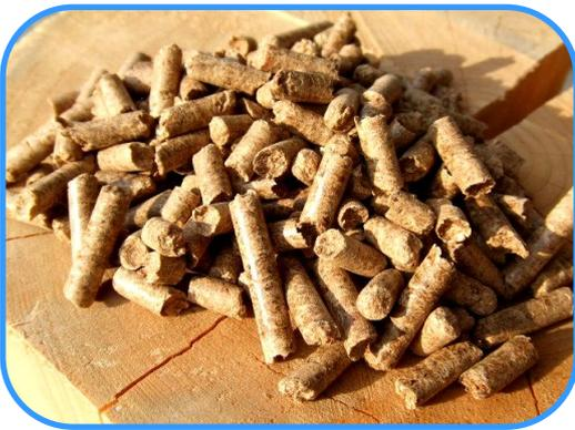
木質ペレットとは、間伐材等の建材として使われていない木材を破砕して粉状にしたあと、乾燥・圧縮して円柱状に固めて作られる燃料です。100%木のみを原料としており、接着剤等の添加物を一切使用していません。未利用の森林資源を原料としているので、利用後に植林するというサイクルを繰り返せば、再生がいくらでも可能な燃料です。また、森林資源を有効に使えるだけでなく、国内での調達が可能であるため、エネルギーの自給自足が可能になります。欧米では、海外産の化石燃料に依存した社会から脱却するため、一般的に普及しています。
