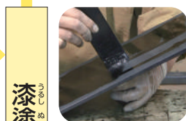
木の反りや割れを防ぐための下地の処理をし、表面を黒色や朱色などに塗り上げます。
