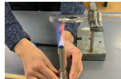
「酸化銀の熱分解」実験動画
