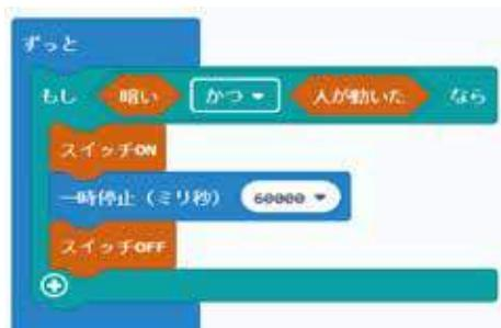
暗くて、かつ、人が動いた時だけ電気が流れ、60秒後に自動的に止まる。
