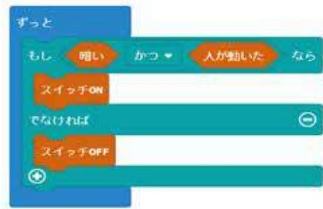
暗くて、かつ、人が動いた時だけ電気が流れ、そうでなければ、電気は流れない。
