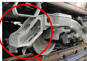
交換した排障器腕
