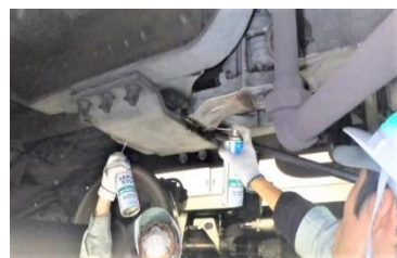
走行時の異音を低減するための連結器への注油作業
