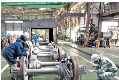
車輪はめ替え更新後の検査
