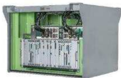
自動列車運転装置（送受信部）
