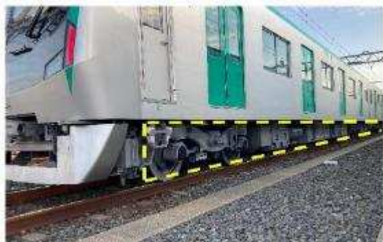
床下の制御装置やモーター
