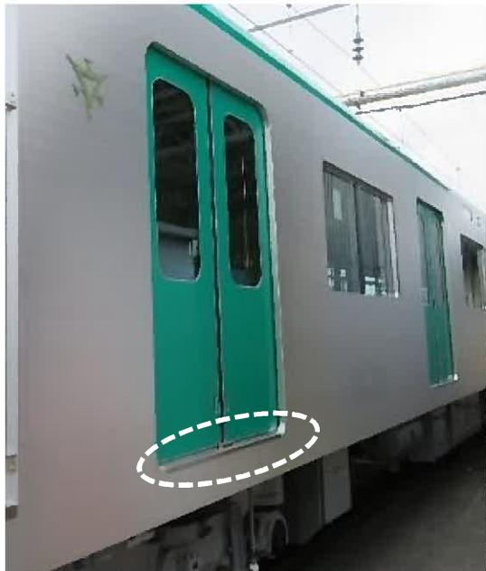
台車の構造を変更し、高さを下げることで低床化を図り、また、ドア出入口下部のステップの形状をホーム側に傾斜することで、定員乗車時におけるステップとホームの段差を約 2 cm まで低減し、車椅子を使用する方々をはじめとするお客様が乗降しやすくなりました。
