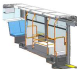
【大きな手荷物を置くスペースを設けた車内レイアウト】
