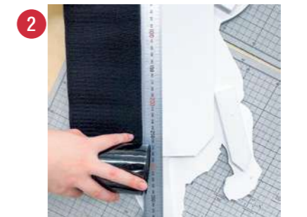
パネルの裏にマジックテープを貼り付けます。
