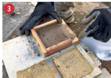
粘度を型枠で成形する。
