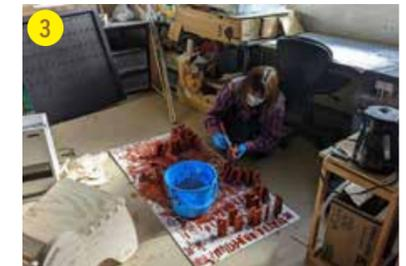
3 蒲鉾板に弁柄、枠に松煙、ダボにチタンを柿渋と混ぜて塗装する。
