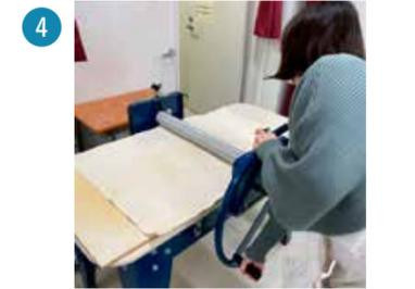
4 スラブローラーを使って陶板を伸ばしています。色の違う粘土を組み合わせるローラーで伸ばし、その上に大学内で取れた葉っぱや小石、古くなったレースなどを置き、一緒にローラーで伸ばして型を付けました。どのくらいの厚みが壊れにくいのか、反らないように何回伸ばせばいいかの、回数を重ねてだんだん分かりました。
