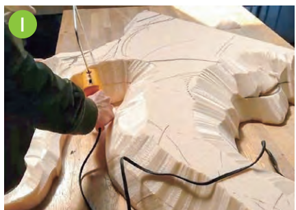
断熱材からスチロールカッターで形を切り出し、和紙を張り子することで表面を整えます。着色はアクリルスプレーです。
