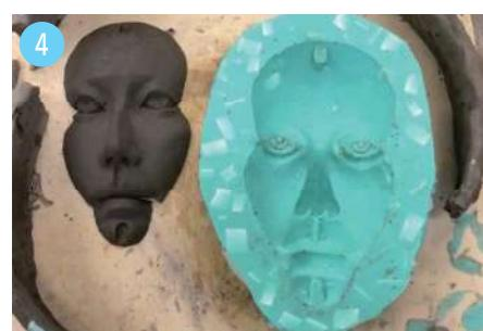
粘土で造形した原型をシリコンで型を取ります。柔らかい素材なので抜け勾配を無視できます。
