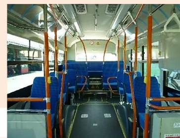
通常のバスより, 車両後部の通路幅が 広いラッシュ型車両(車内)
