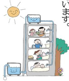
私たちが使用している水道水には本管から直接給水する直結方式と、いったん受水槽にためてから給水する受水槽方式があります。一般的に、水圧が不足する3階以上の建物や大量の水を使用する施設の飲用水は、受水槽方式で給水されています。
