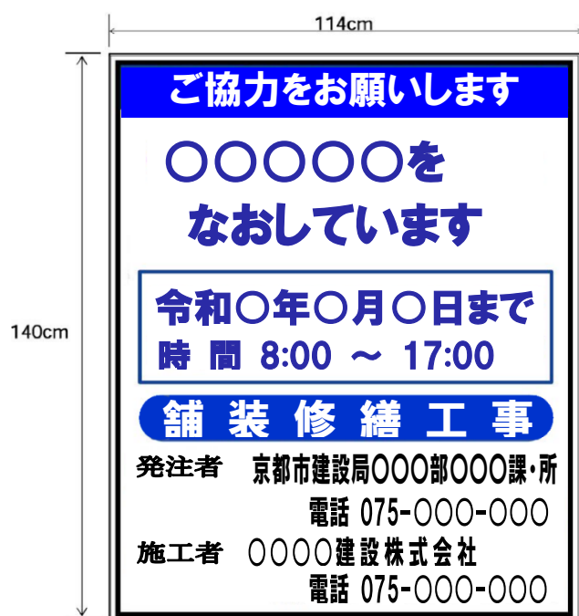
(例) 道路工事の標示板
