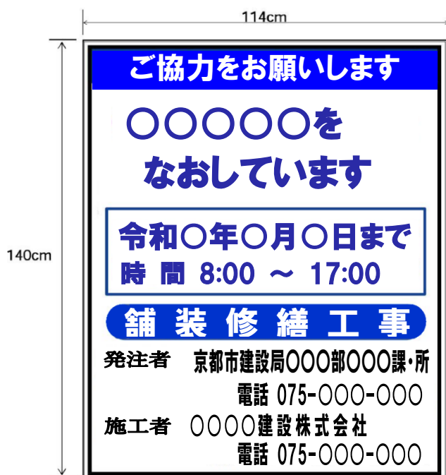
(例) 道路工事の標示板
